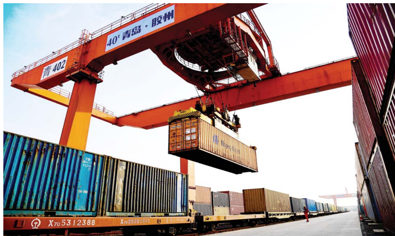
在青岛胶州湾国际物流园，龙门塔吊在往中亚班列上装载货物。
