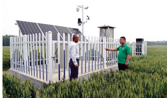
邹平县元瑞农业科技公司的农田监测系统可收集农作物生长温湿度、气压、光照等10多项数据传输回终端，用于指导田间生产。
