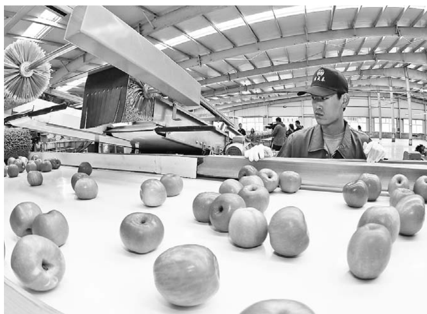
在烟台一家水果公司，出口美国的苹果经过自动化苹果清洗机。（资料片）
