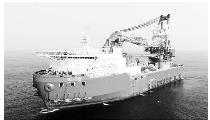
“德合”轮总长199米，型宽47.6米，型深15米，满载排水量达75127吨。
