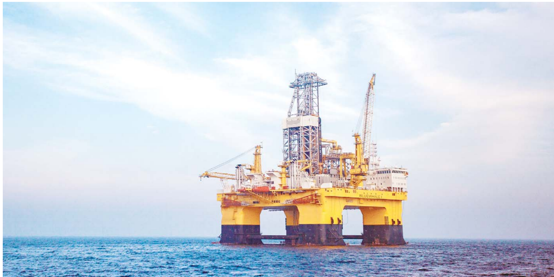
中集来福士公司建造的全球最先进的超深水双钻塔半潜式钻井平台“蓝鲸1号”交付使用。(□新华社发)
