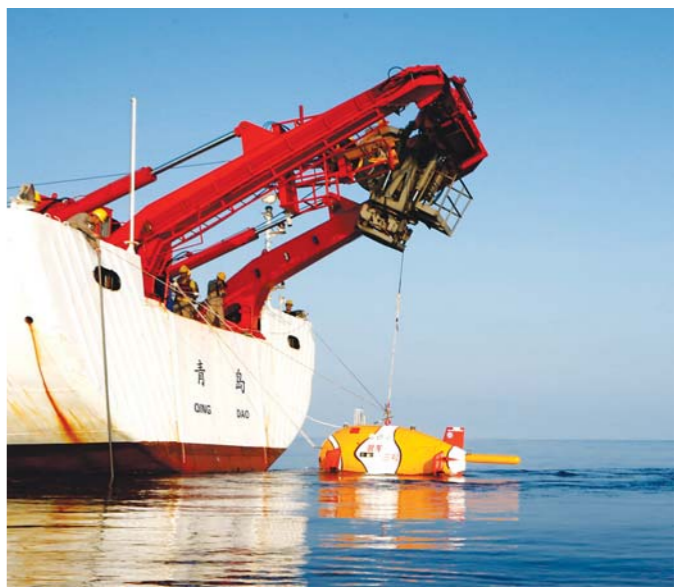
科考队员在布放“潜龙三号”，从母船将其放入水中。本航次中，“海龙”“潜龙”系列潜水器共完成12次下潜，获得大量试验数据和丰富调查资料。一个月前，“大洋一号”科考船停靠位于青岛的国家海洋局北海分局科考基地码头。（□新华社发）
