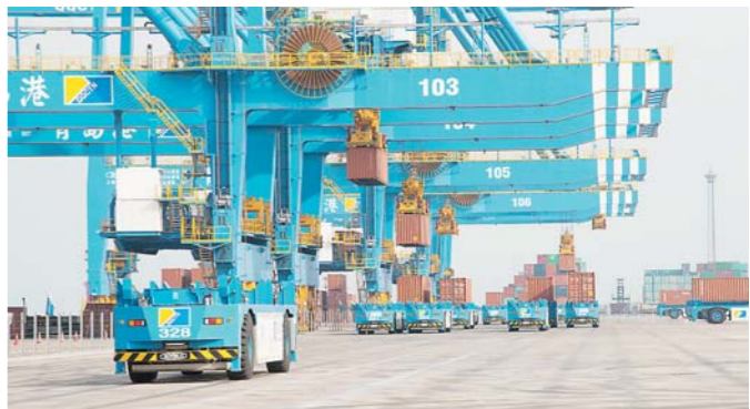
青岛港建成亚洲首个自动化码头——青岛港全自动化集装箱码头。运营一年来，这个码头完成集装箱吞吐量79.48万标准箱，单机平均作业效率比全球同类码头高出50%。（□CFP供图）
