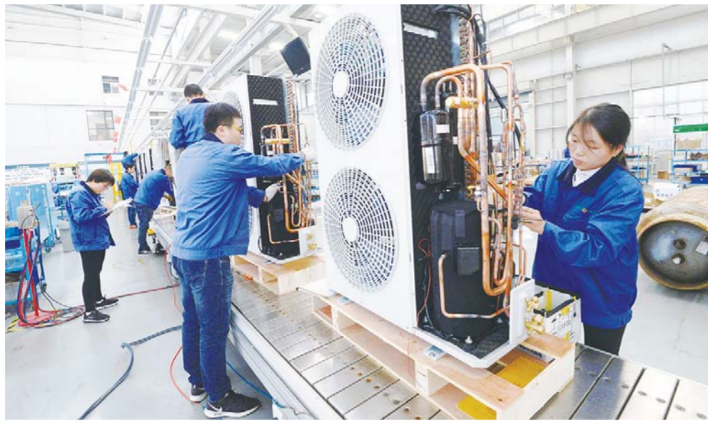
△1月17日，在山东阿尔特普节能装备有限公司商用机生产车间里，工作人员正在安装商用空气源热泵机组。
