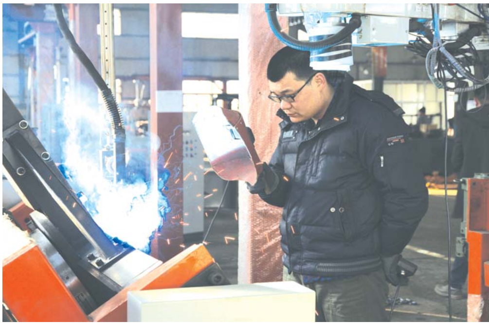
图为范庆阁正在查看机器人塔脚焊接情况。
