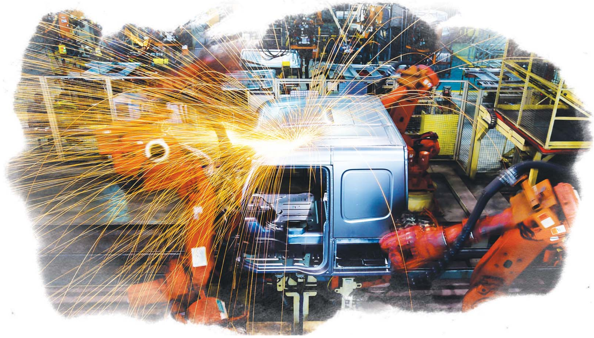
中国重汽集团济南卡车公司，机器人正在进行焊接作业。（□新华社发）
