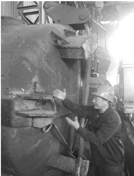
党祎贤在泰钢集团炼钢厂车间介绍他们研制成功的钢包吹氩自动对接机构。
