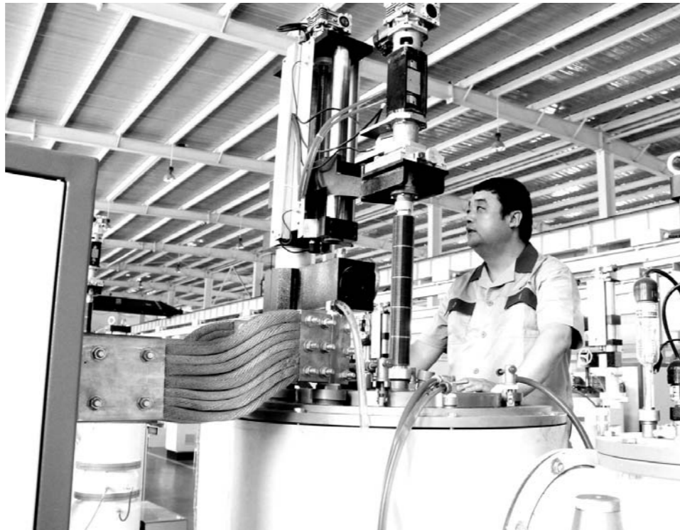
宋旭波操作刚刚安装好的晶体生长炉。(资料片)
