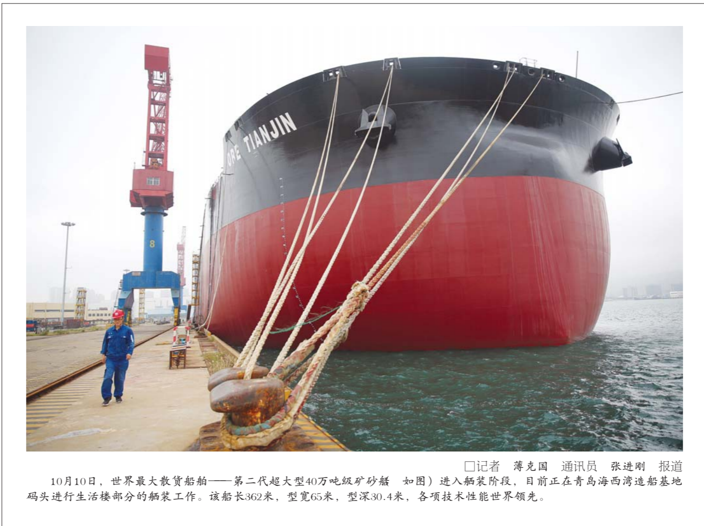
10月10日,世界最大散货船舶——第二代超大型40万吨级矿砂船(如图)进入舾装阶段,目前正在青岛西海岸造船基地码头进行生活楼部分的舾装工作。该船长362米,型宽65米,型深30.4米,各项技术性能世界领先。
