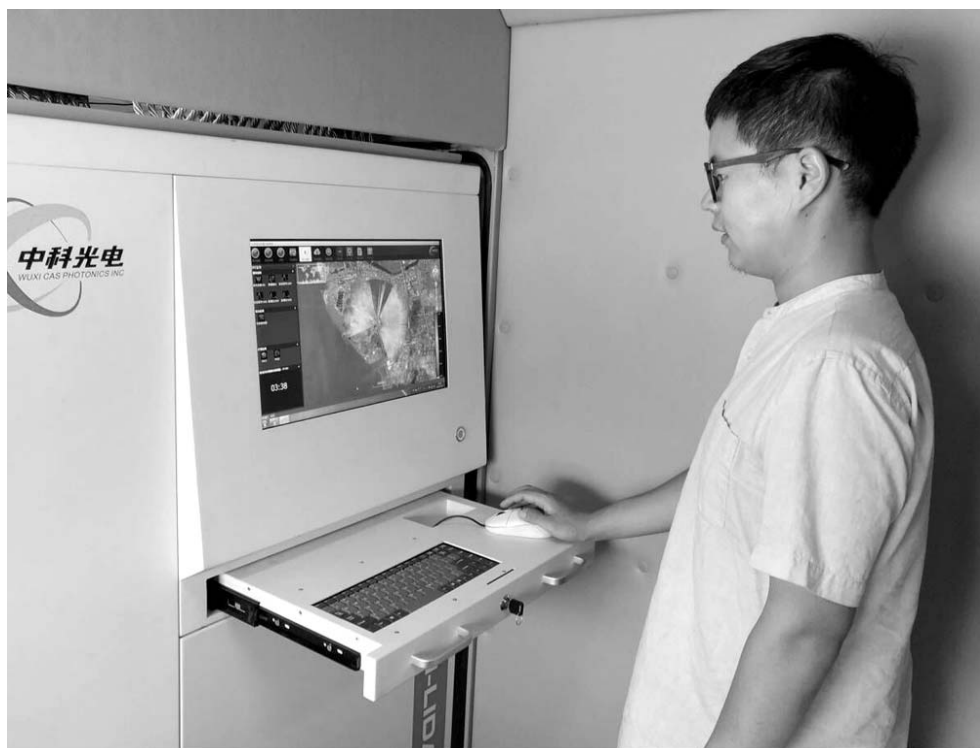
在移动式激光雷达扫描车内部，工作人员利用车载电子设备，收集、处理和分析数据。
