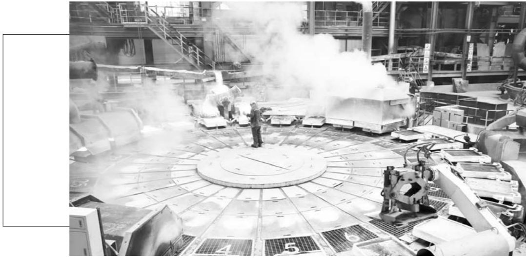
□周广学 李广寅 报道 日前，在东营经济技术开发区方圆有色金属有限公司，冶炼工人在圆壳浇铸机上作业。该公司研发的新一代铜冶炼技术体系，成为我国工业领域输出的首套具备国际水平的成套装备工艺。东营市以新旧动能转换为动力，积极推动科技和人才资源向企业聚集，让企业在人才科技工作中“唱主角”，成为推动经济转型发展的重要力量。
