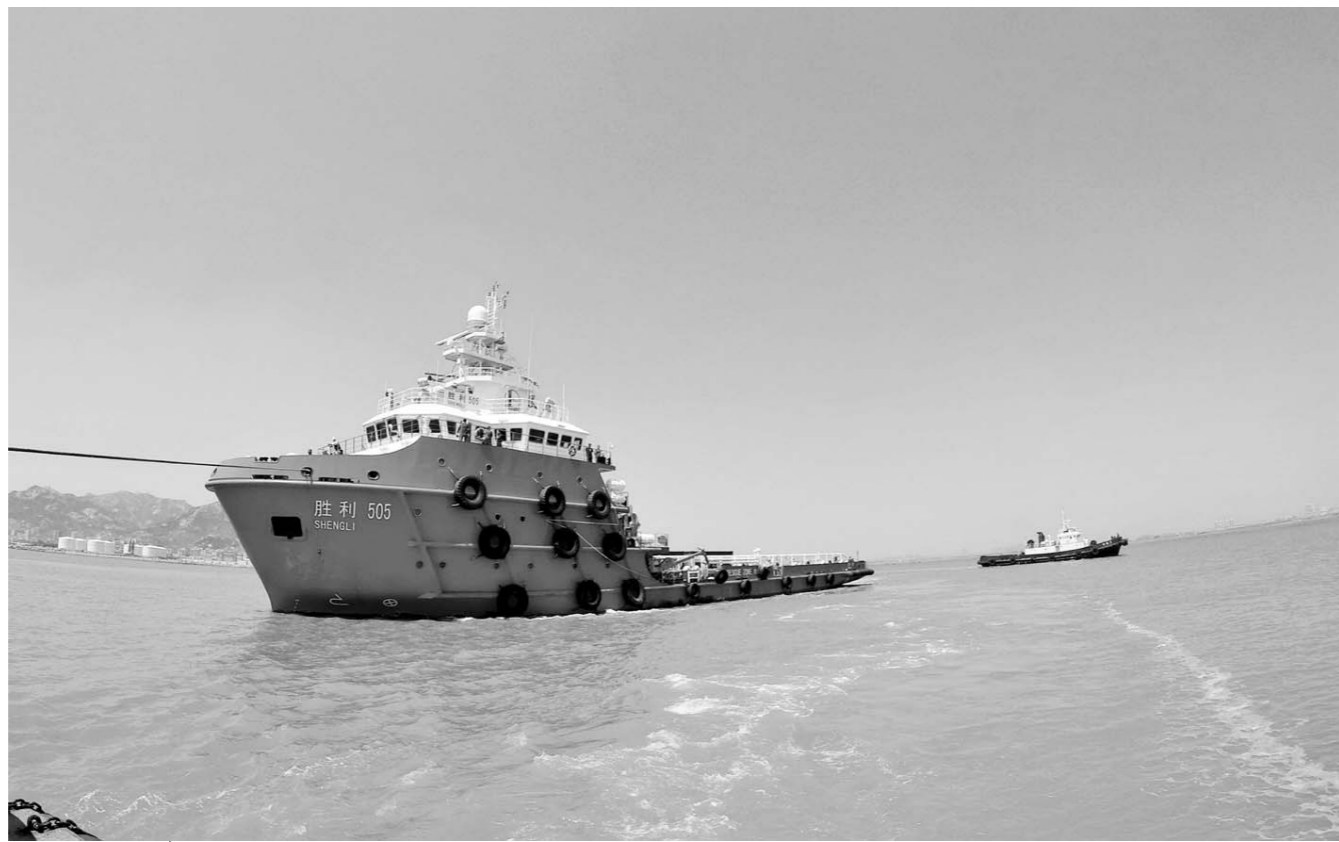
□ 崔程亭 李福起 报道 5月10日上午，中国石化胜利油田新建6500马力溢油回收船——胜利505船，在山东省荣成黄海造船有限公司建成投产。胜利505船总投资11110万元，总收油能力为200立方米/小时，主机为两台直列、四冲程德国MAK 8M25C柴油机，单台最大持续功率2400千瓦，为山东省马力最大的溢油回收船。
