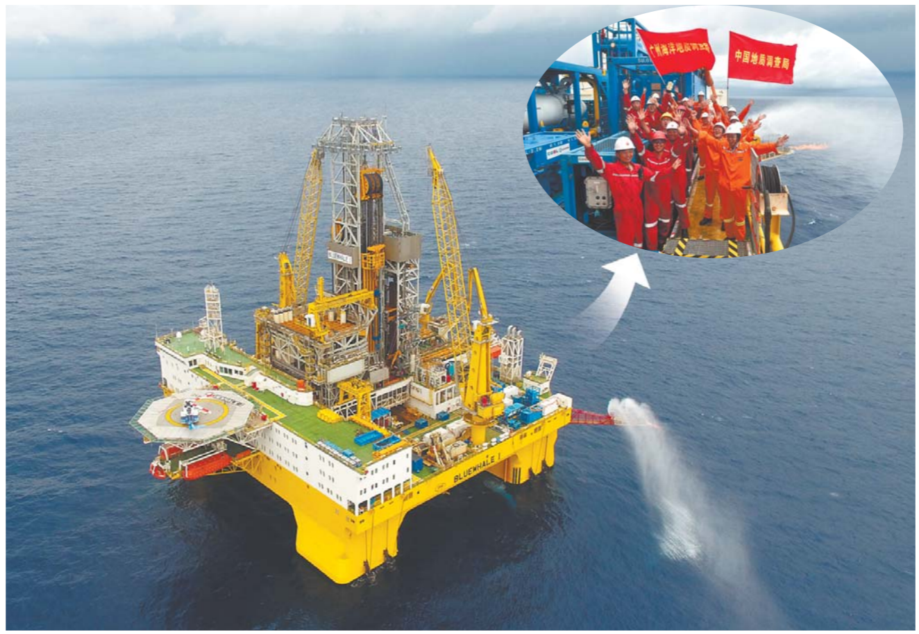
大图:进行天然气水合物试采作业的“蓝鲸一号”钻探平台。小图:工作人员庆祝天然气水合物试采稳定产气。
