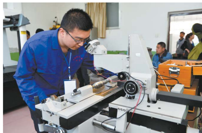
裁判室中，裁判员正用配置显微镜的仪器查看车工选手制作的零件。
