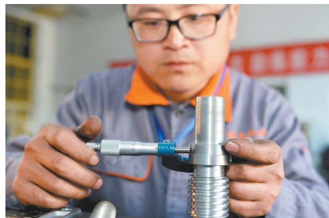
车工比赛中，选手用卡尺测量车床加工零件的外径。
