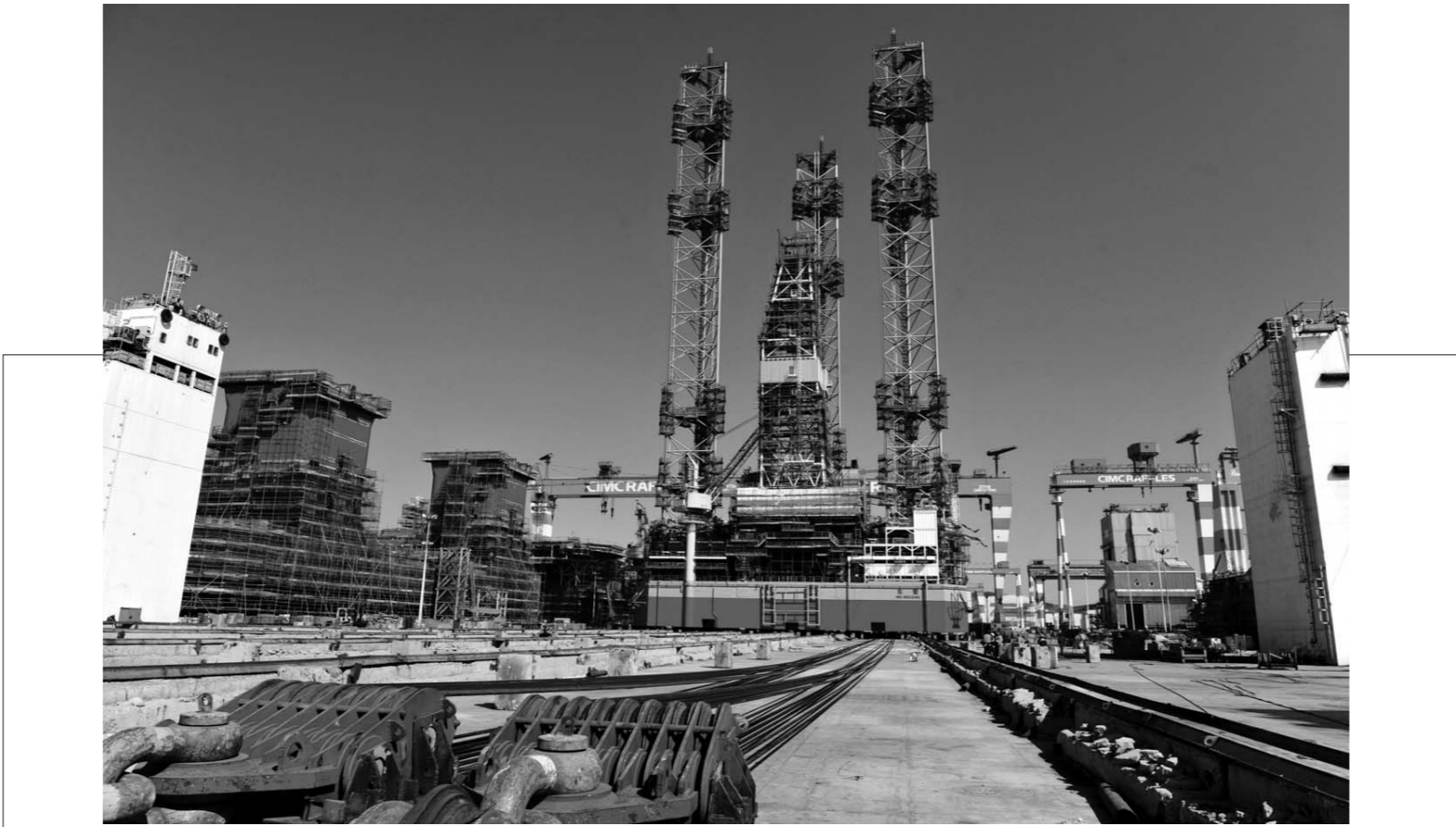
3月9日，胜利90米自升式钻井平台顺利下水，标志着中石化胜利石油工程公司90米自升式钻井平台主体建造基本完成，转入后期调试和装配阶段。作为中石化集团公司重点建设项目，也是胜利石油工程公司目前建造尺寸最大、配套最先进的首条桁架式海上钻井平台，胜利90米自升式钻井平台可适合于世界范围内7~91.4米水深海域的钻井作业。
