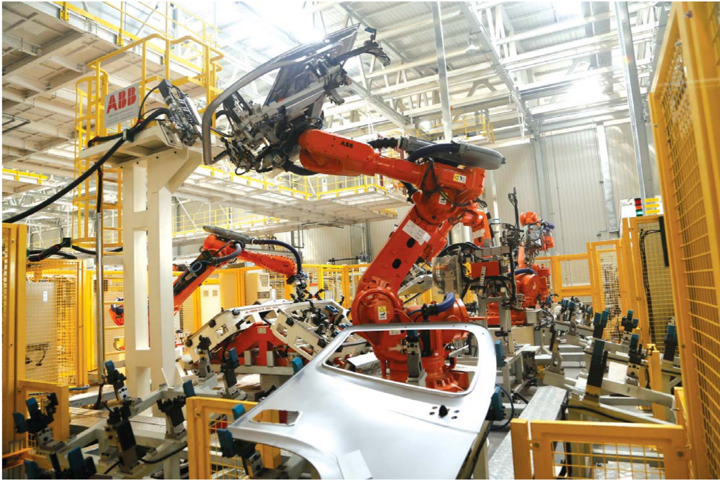
在福田汽车诸城厂区M4生产车间，清一色的机器人在摆动机械手臂进行焊接、组装、喷漆等作业，防护栏外很少见到人走动。图为在福田汽车诸城厂区M4生产车间防护栏内，多台机器人正在进行联合作业。
