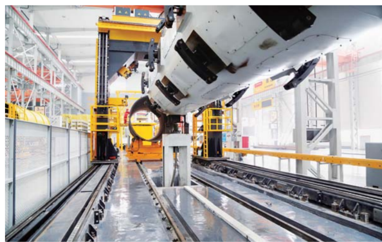
△骏马石油装备有限公司自主研发的全世界首条石油装备全自动化生产线成功实现了零人工焊接
