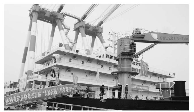
1月9日,由中铁大桥局投资建造的"大桥海鸥"号起重船在青岛西海岸新区交付使用。这艘起重船起重量3600吨,主钩 最高起升高度距水面以上110米,是目前国内起重量最大、起升高度最高的起重船。
