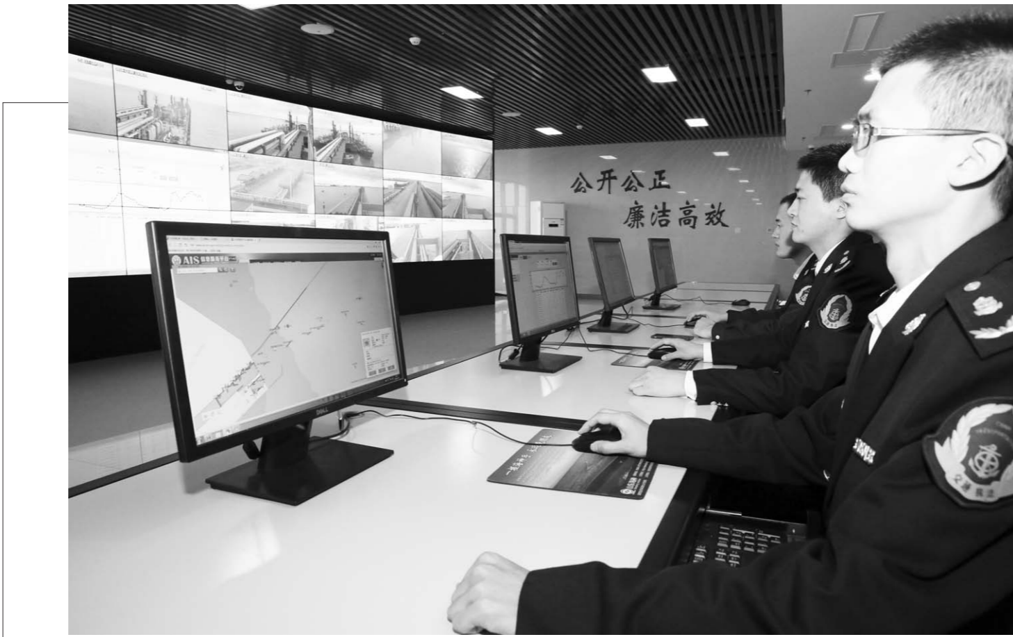
□广学 李明 文浩 报道 12月9日，工作人员在东营港调度管理中心进行系统测试。当日，东营港调度管理中心通过验收，进入试运行。中心配有港口视频监控、船舶自动识别系统、无人机监测系统、海况气象监
