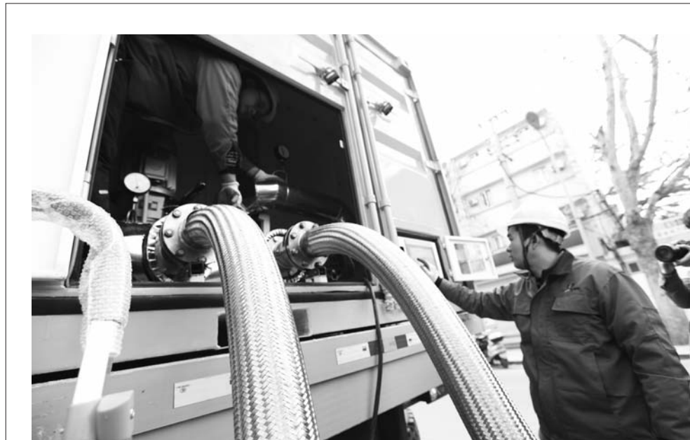
□记者 禹亚宁 通讯员 秦清 报道 12月8日，一辆黄色移动热源车停在历下区实验小学门口，为小学换热站输送热量。 济南热力公司今年定制了3辆新型移动热源车，一旦有热源不稳定等情况出现，即可开赴现场保障居民的供暖质量。以供热面积8000平方米的历下实验小学为例，1台热源车可至少保证学校10小时供暖。移动热源车的内部设备采用相变储能材料制成，利用潜热进行储热和放热，寿命可长达40年。
