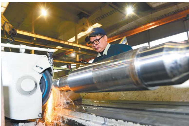
砂轮飞溅的电光火石中，孙佑军能根据枢轴的温度预判其缩进的数据。
