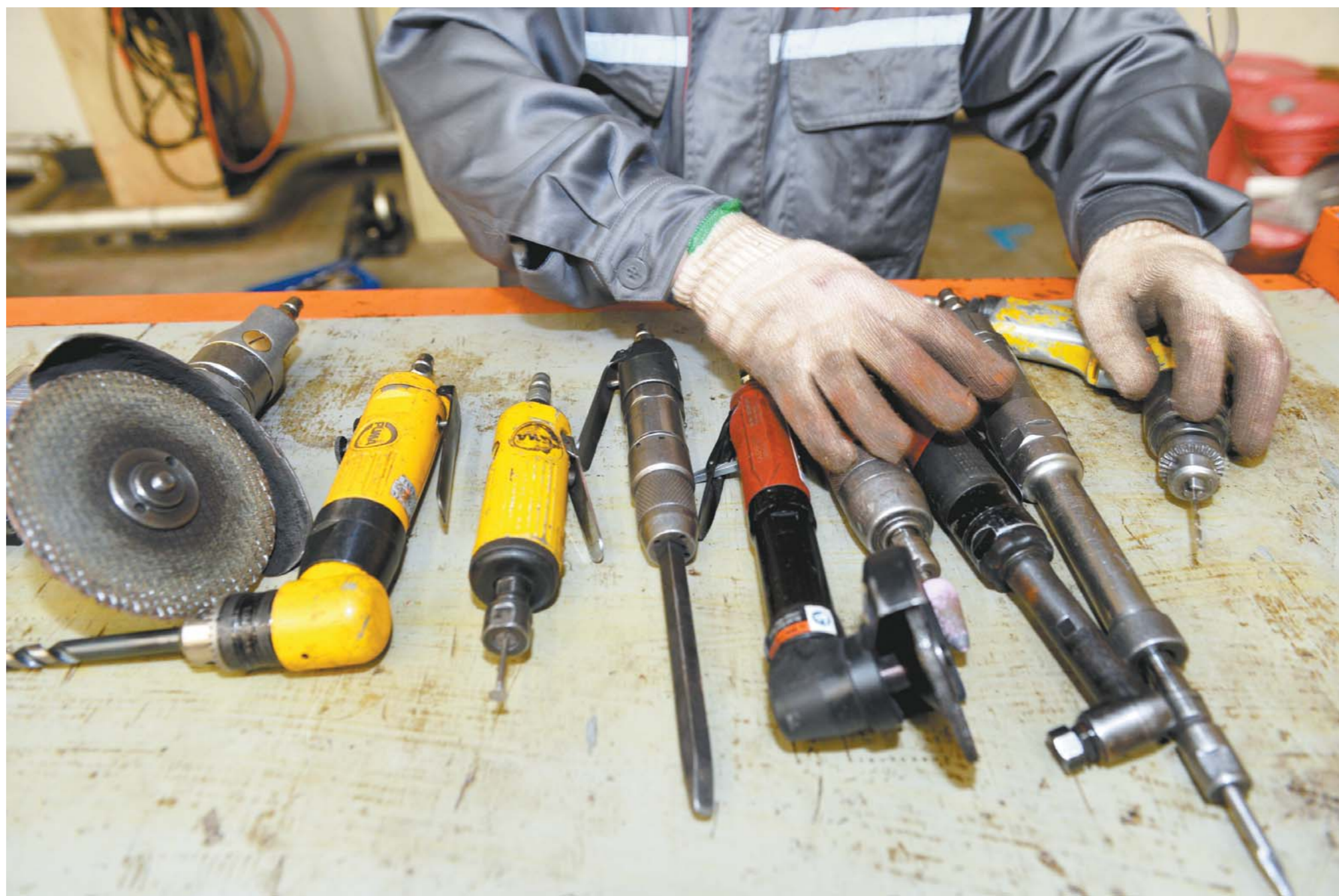
宁允展的工具橱前，他正在认真地整理各种风动打磨机、风钻、风铲。工作之余，他喜欢摆弄、研究使用各种工具。
