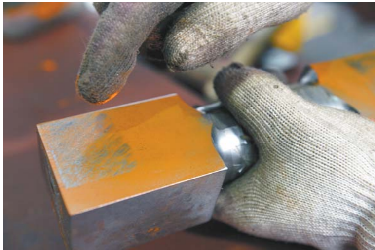
车间里，宁允展查看刚从定位臂上取下的检测芯轴，芯轴上红丹粉显示的印迹用来检测接触面积。
