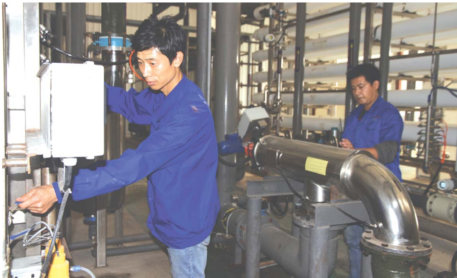
图为在诸城东晓生物科技有限公司净水车间,工作人员正在检查水质PH、ORP、CT数值。
