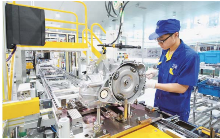
△盛瑞SAT装配测试线工作人员正在组装变速器成品
