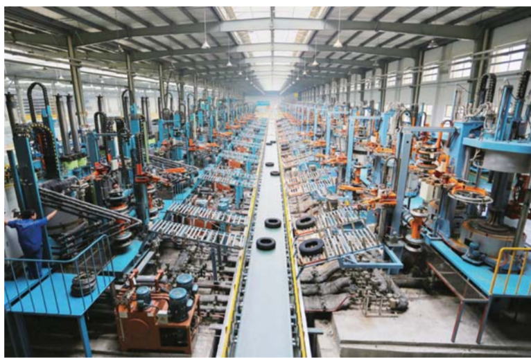
△山东宏盛橡胶科技有限公司硫化车间硫化机流水线
