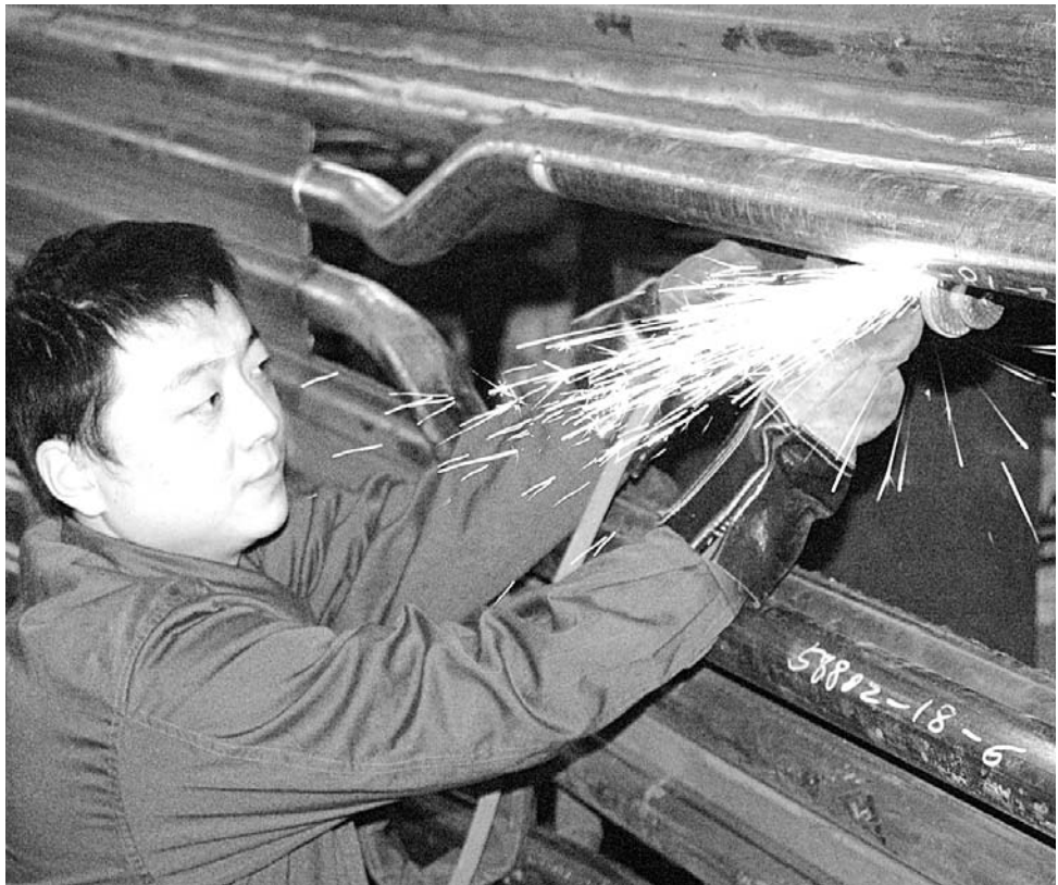
济南锅炉集团公司高级焊接技师、济南市焊接首席技师房迎在焊接锅炉部件。
