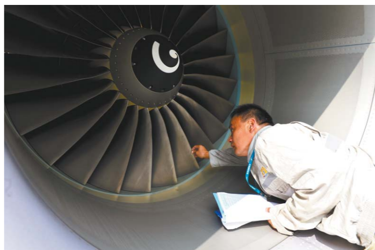
张松强在认真检查发动机叶片。
