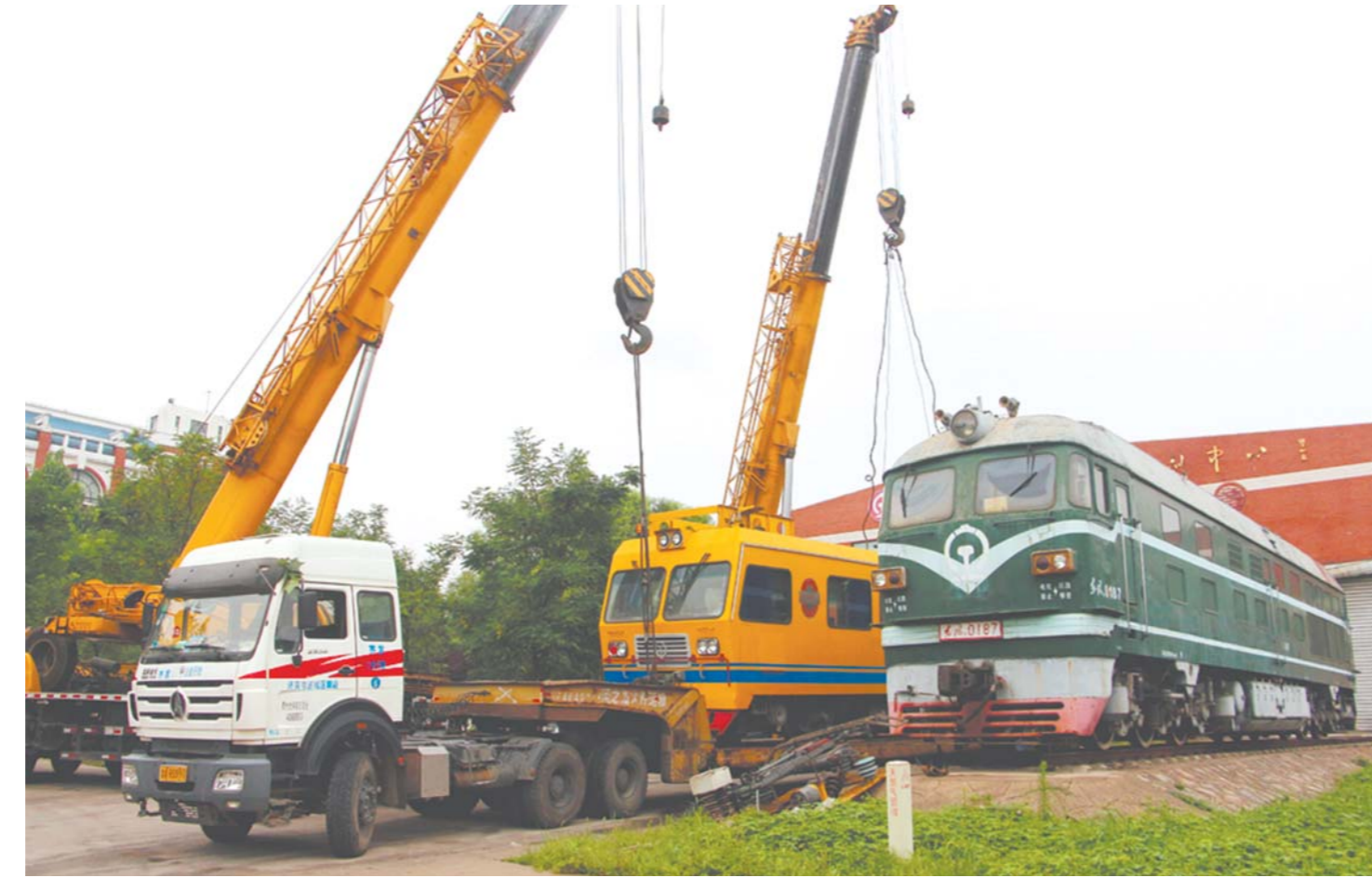
6月23日，山东职业学院“火车家族”迎来新成员，素有“高铁救护车”之称的铁路接触网架线作业车正式落户该院。此次落户的接触网架线作业车型号为DA11，DA11型接触网架线作业车主要用于电气化铁路接触网的架设、维修、日常检查与保养作业。
