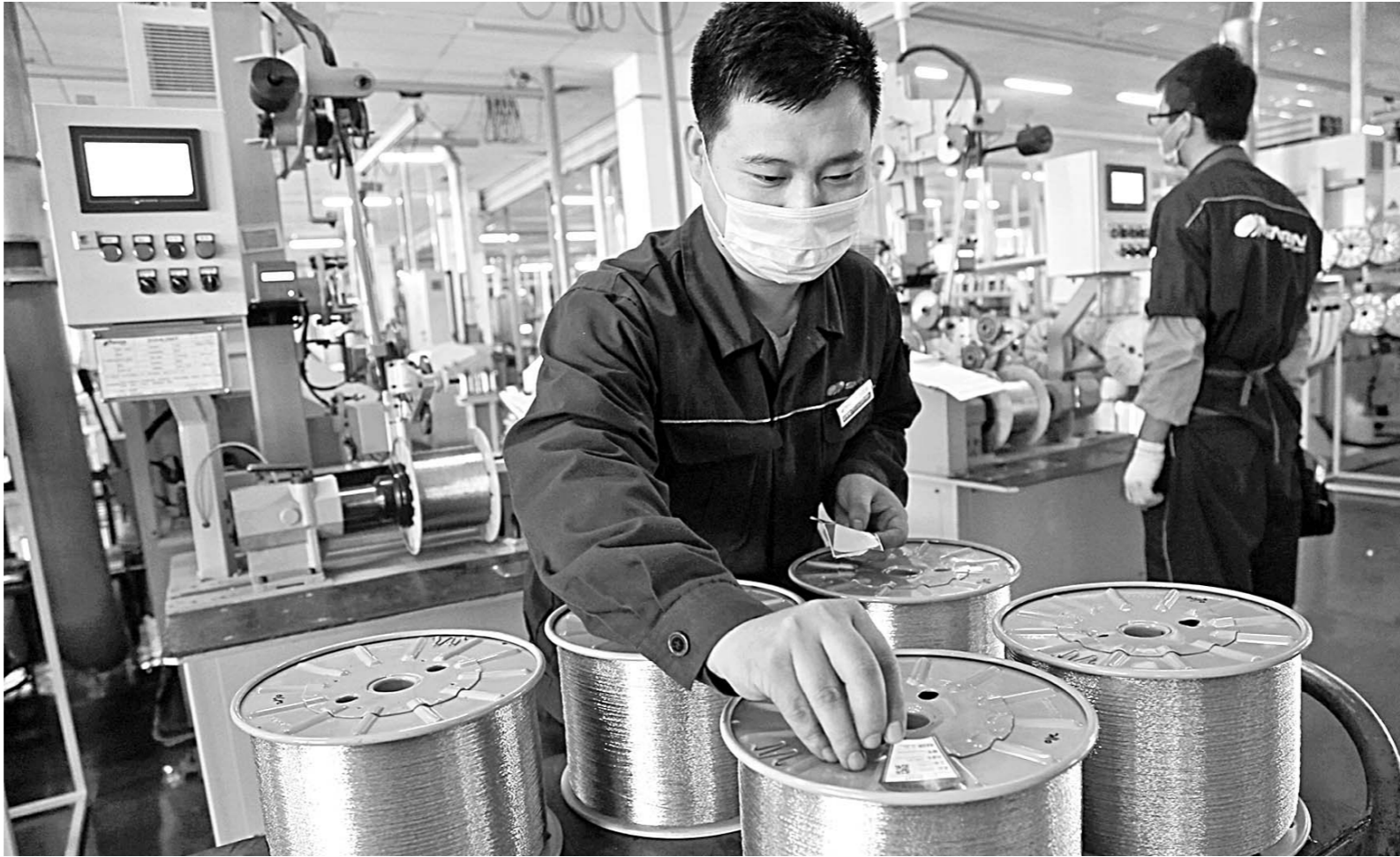
□中平 李洁 广寅 报道 日前，在垦利经济开发区胜通钢丝绳有限公司厂区内，工人正在为成品钢丝绳贴上二维码。据了解，该公司通过智能化信息系统对生产过程进行智能控制，产品合格率较原来提高了1%-2%，整体生产效率提升了30%。
