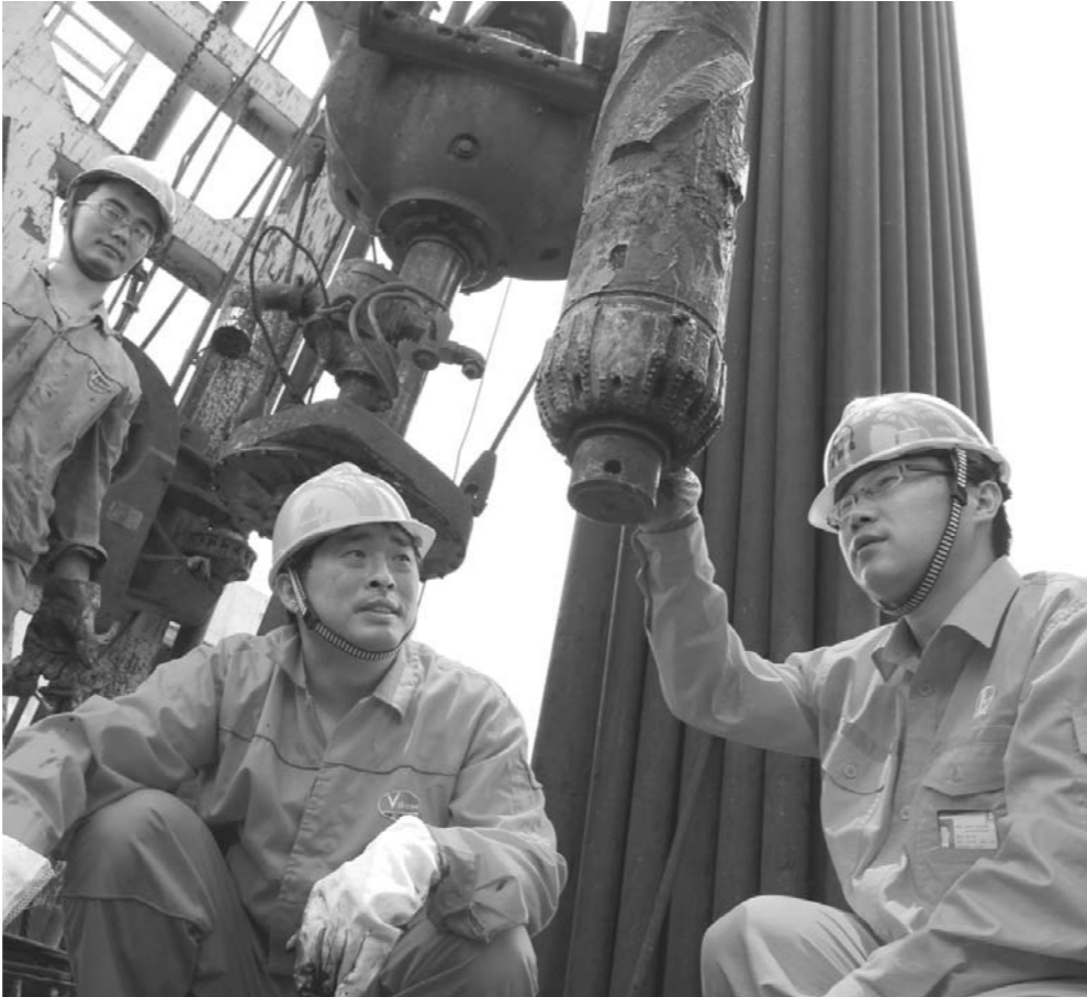
胜利油田钻井院的技术人员在为客户提供取心技术服务。(资料图)
