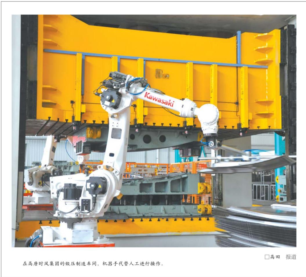
在高唐时风集团的锻压制造车间，机器人代替人工进行操作。
