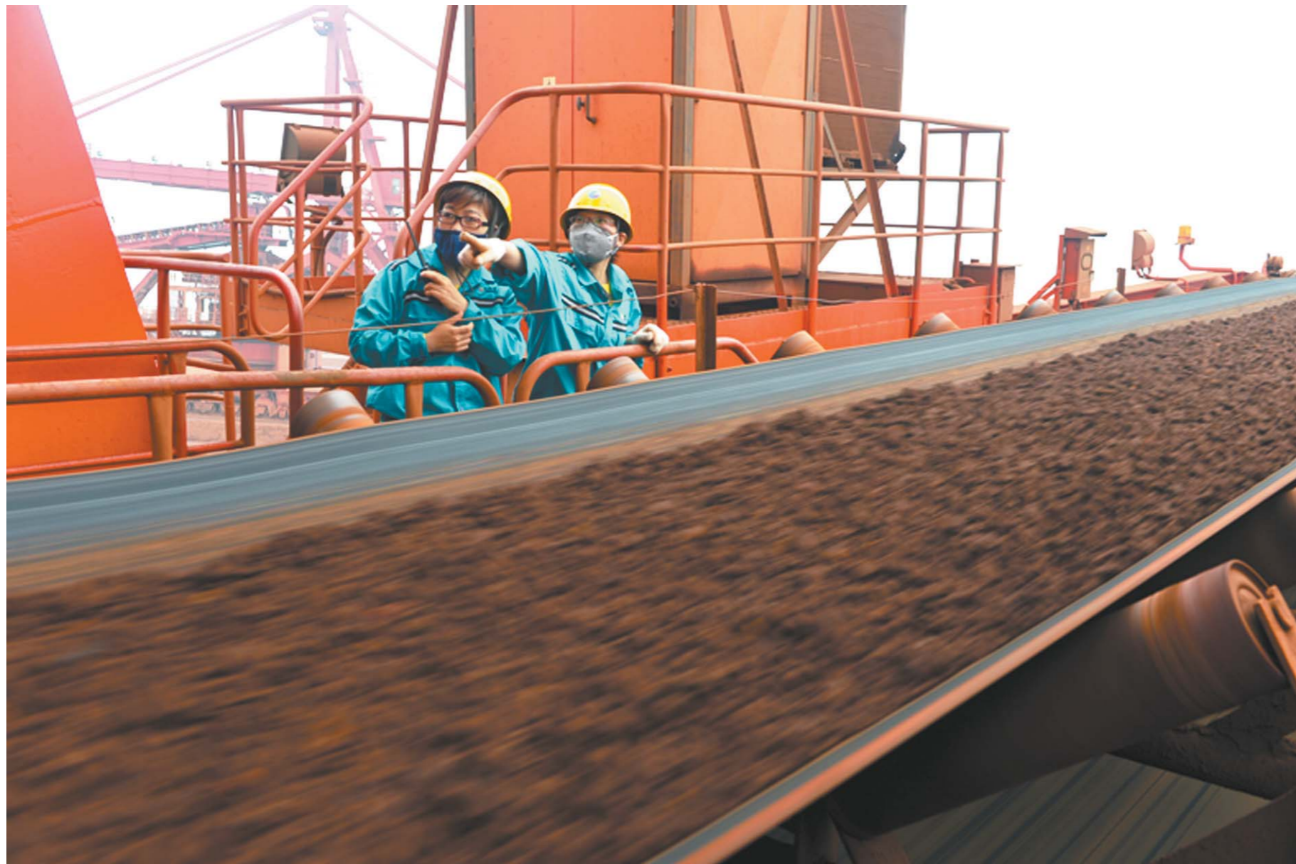
高速运转的堆取料机传送皮带旁，陈晓红与女子班的刘召美大声交流有关避免皮带跑偏的技术问题。
