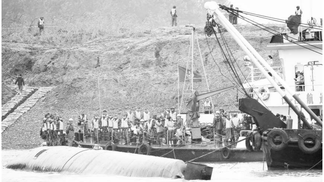
新华社发 6月3日，救援人员对沉船展开营救。在科学施救方面，有三种方案可供救援人员选择：切割船体；吊起船体；潜水员水下探摸搜寻。救援人员将在船体底部中前部切一个55厘米乘60厘米的长方形口子，以便潜水员进入舱体探查。
