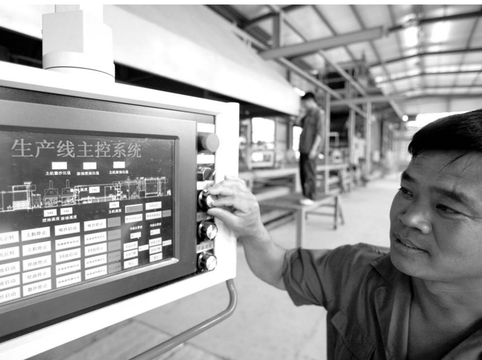
宇虹防水材料有限公司高铁专用防水生产线。
