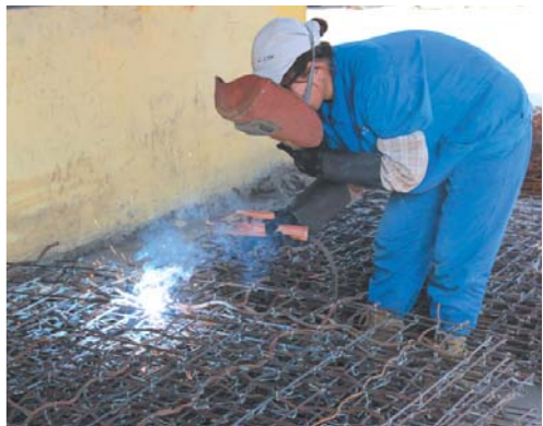
□记者 左丰岐 报道 金属编织厂职工正在将钢丝绳焊接成井下支护用的金属网。
