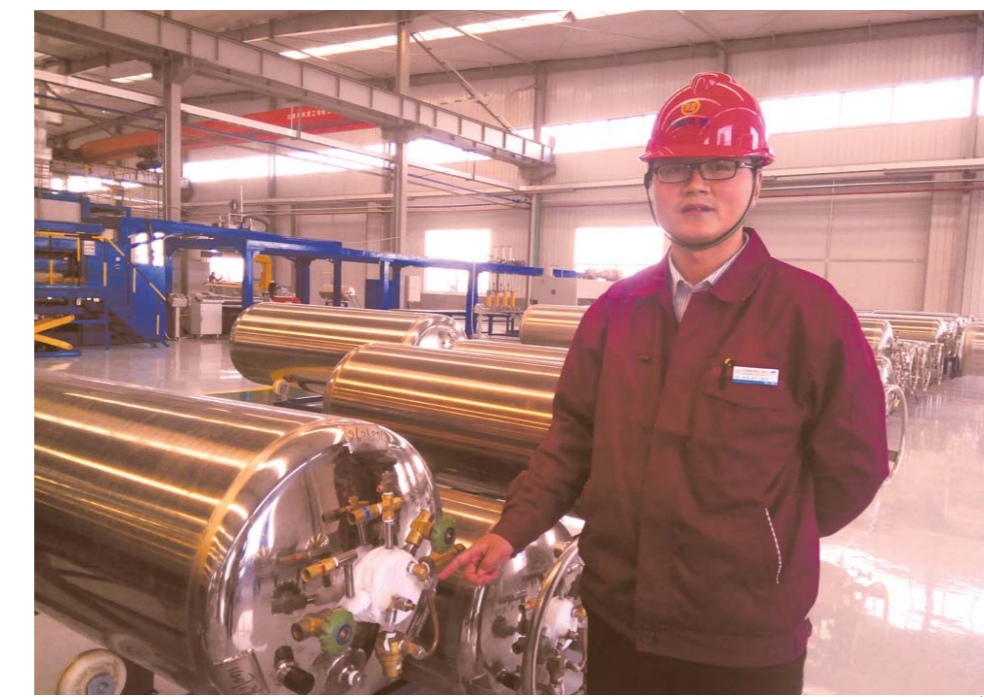
联盟化工生产的LNG气瓶正在接受氨气测试。
