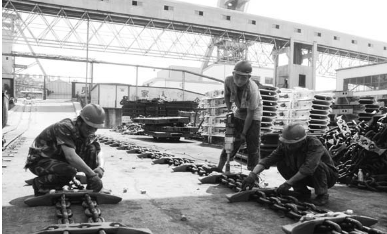
□刘庆路 报道 山东能源枣矿集团新安煤业公司发挥矿井自备机电制修和综机维修两大车间的作用，提高各类机械设备修复自制能力、加工修复质量，推广再制造技术，盘活闲置资产。仅今年上半年，该公司就完成修旧利废133.1万元，回收物资726万元，复用412.8万元，节约材料费用622万元。图为该公司机电制修中心职工正在冒着38度高温加工掘进工作面刮板输送机(溜子)。
