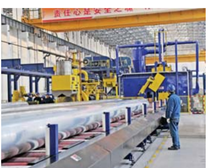
△兖矿综合金业有限公司世界上首台吨位最大、工艺最为先进的150MN铝挤压机
