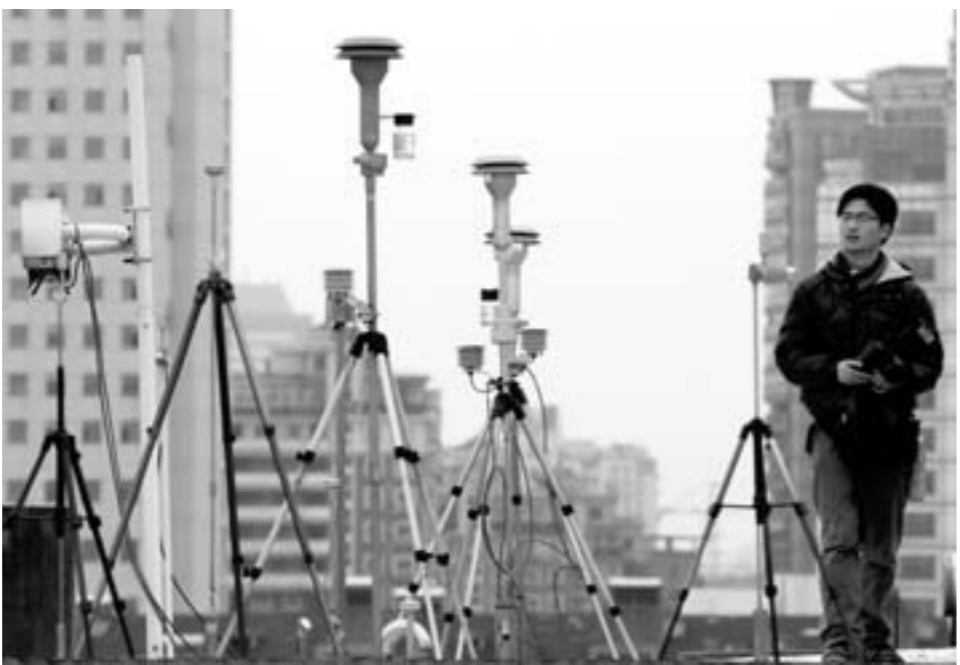
2012年3月1日，杭州朝晖四区的PM2.5监测点向媒体开放。采集仪器置于楼顶平台上，监测器底部有三个脚架，顶部装有一个采样杆...
