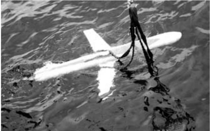
究所研制的水下滑翔机在西太平洋超过4000米的水深处连续多次下潜,最大深度接近1000米,各项指标均表现正常,滑翔机在实验后被成功回收(上图)。
